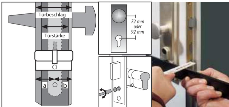
Die Zylinderlänge ist direkt von der Türstärke plus Beschlagdicke abhängig. Viele verschiedene Zylinderlängen stehen Ihnen zur Wahl. Das Messen der zwei wichtigen Zylindermaße ist sehr einfach. Gehen Sie wie auf der Abbildung gezeigt vor. Mit a ist das Innenmaß und mit b die Außenlänge des Zylinders bezeichnet. Gemessen wird immer von der Mitte der Befestigungsschraube für den Zylinder.
